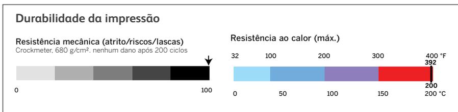
Avaliação de desempenho observado do ribbon à prova d'água da Videojet com receptores e configuração da impressora otimizados.
